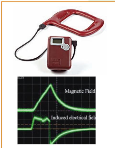
Figura 1 A sinistra I-ONE® terapia. A destra la forma d'onda del campo magnetico, con un picco d'intensità di 1.5 mT (in alto); la forma d'onda del campo elettrico indotto in una sonda standard di 50 giri (0.5 cm $\emptyset$ ) di filo di rame (0.2 mm $\emptyset$ ), con valore di picco 3 mV/cm (in basso).
